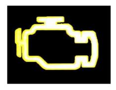
P0100 Luftmassen/Mengenmesser Signal zu groß/ klein
